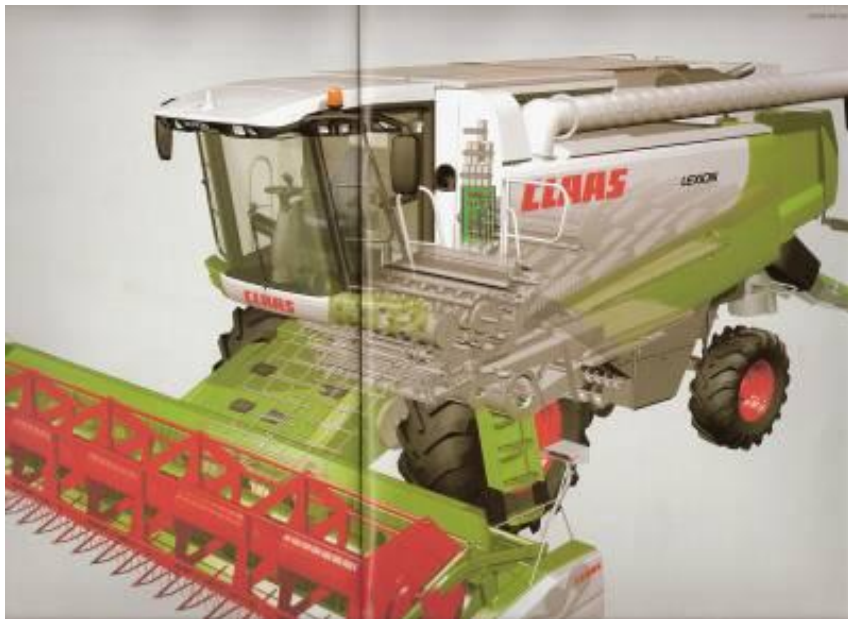
Prostorový řez sklízecí mlátičkou Class lexion 560
