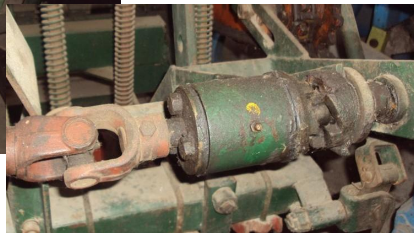
48 SEXJ 125 Zubová spojka – zapínání výsevního ústrojí
