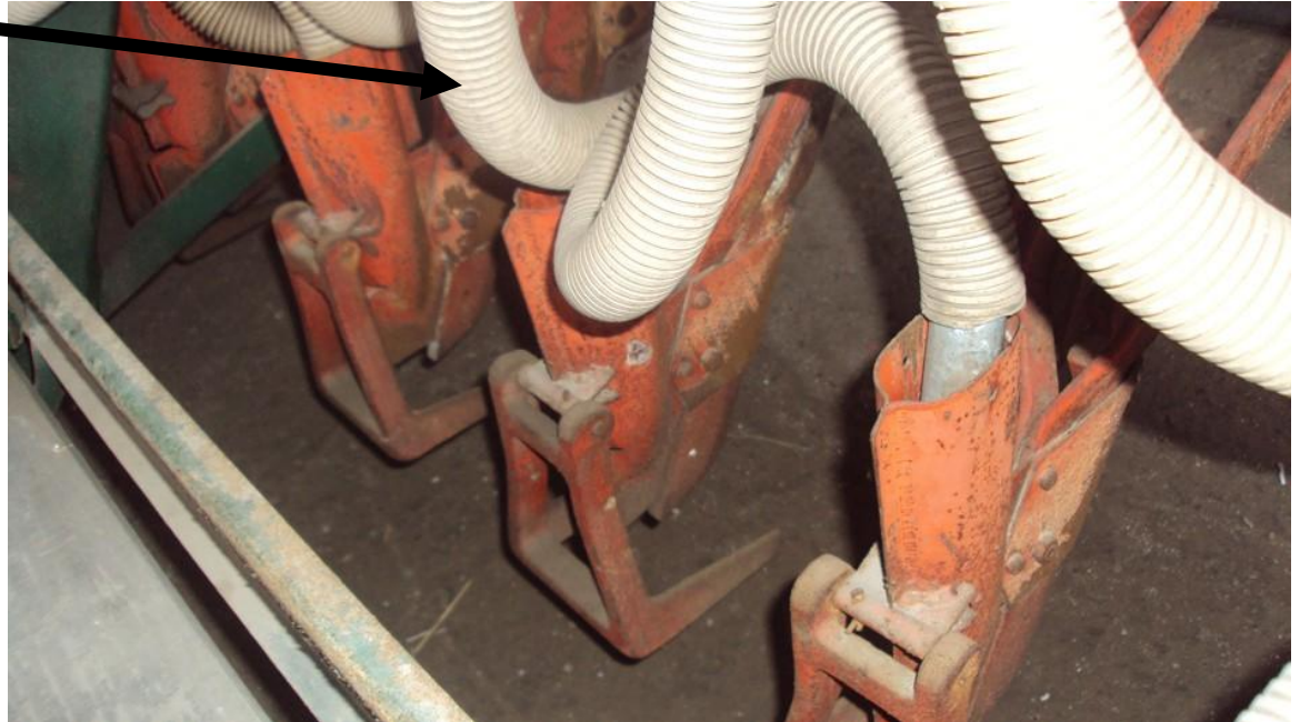
48 SEXJ 125 Výsevní botky radličkové se zavlačovači
