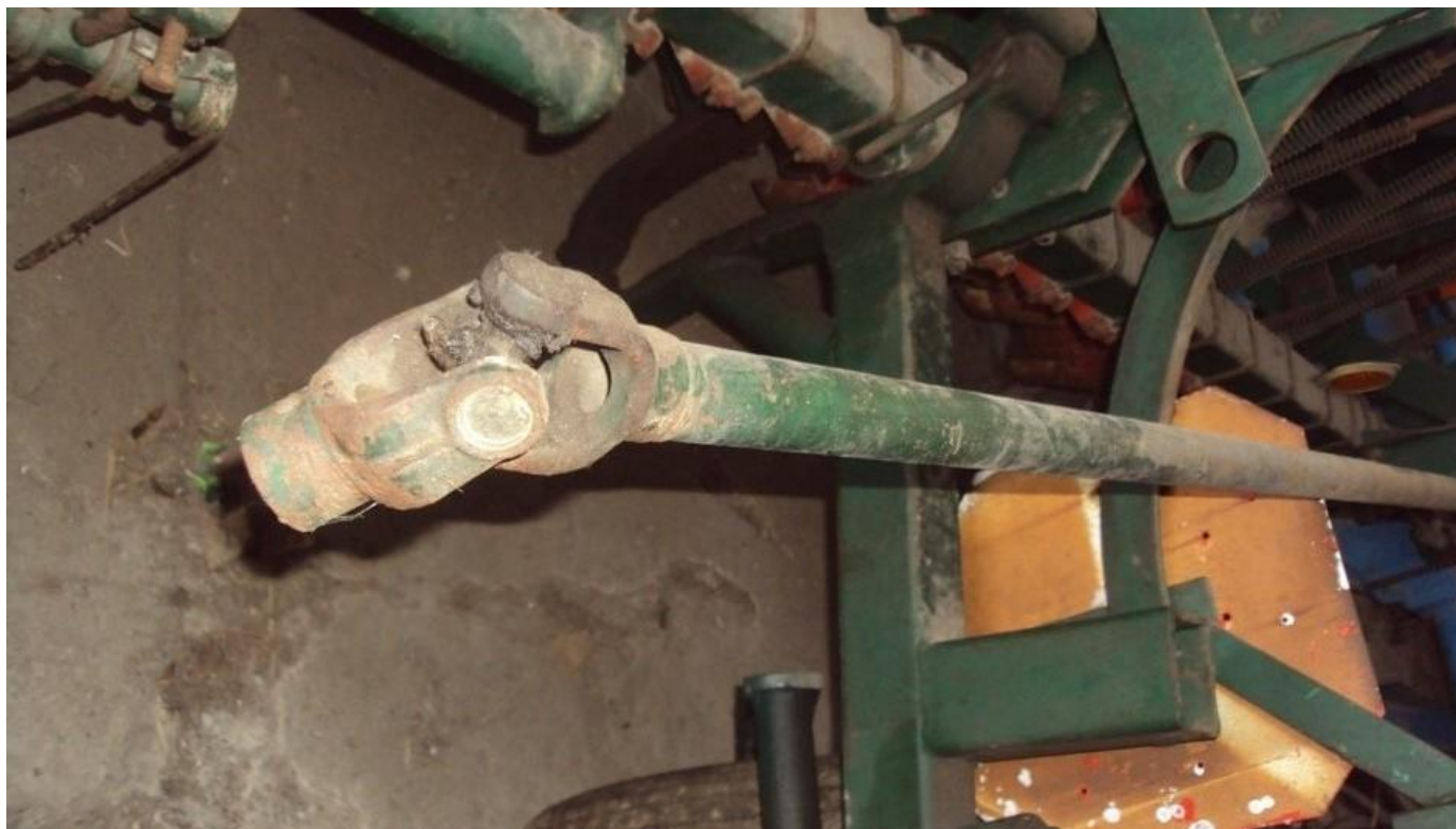
48 SEXJ 125 Kardanová hřídel – pohon od zadního kola traktoru
