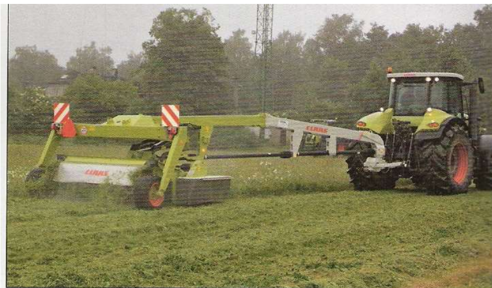
Claas Disco 3500 TC – tento stroj je tažený, se středovou ojí, dovolující snadné manévrování a sečení z jedné strany pozemku
