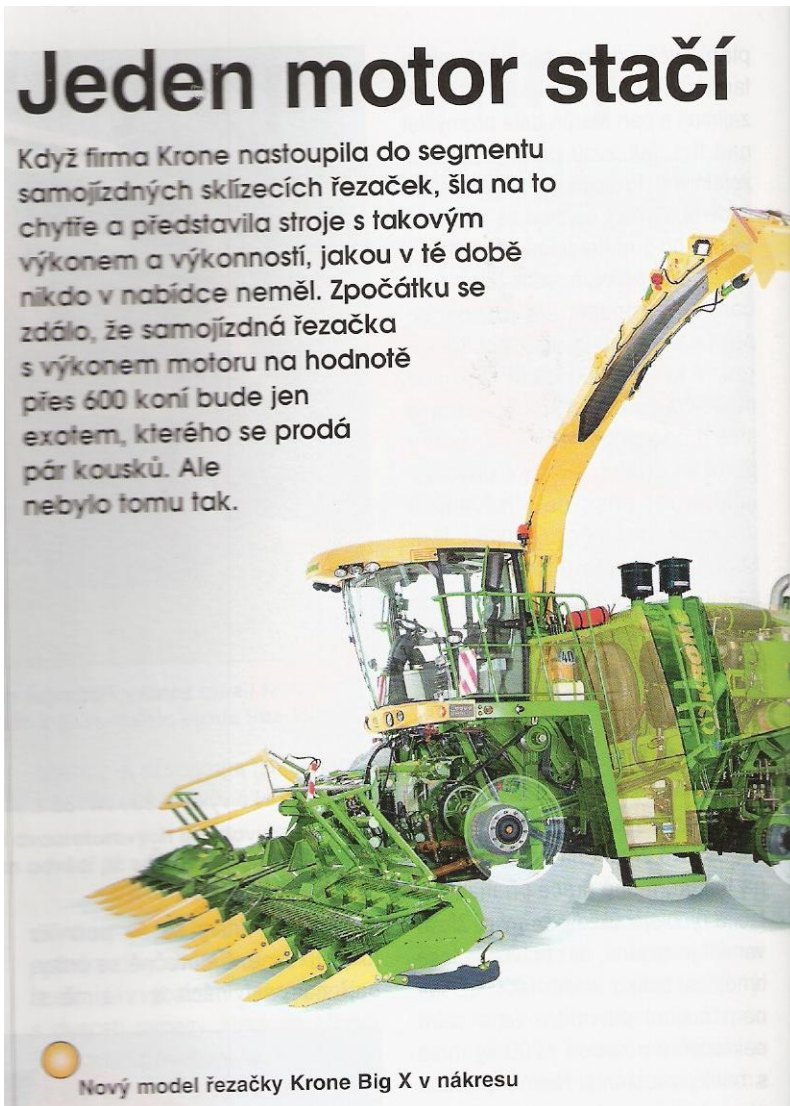
Obr. Prostorový řez sklízecí řezačkou s adaptérem na kukuřici
