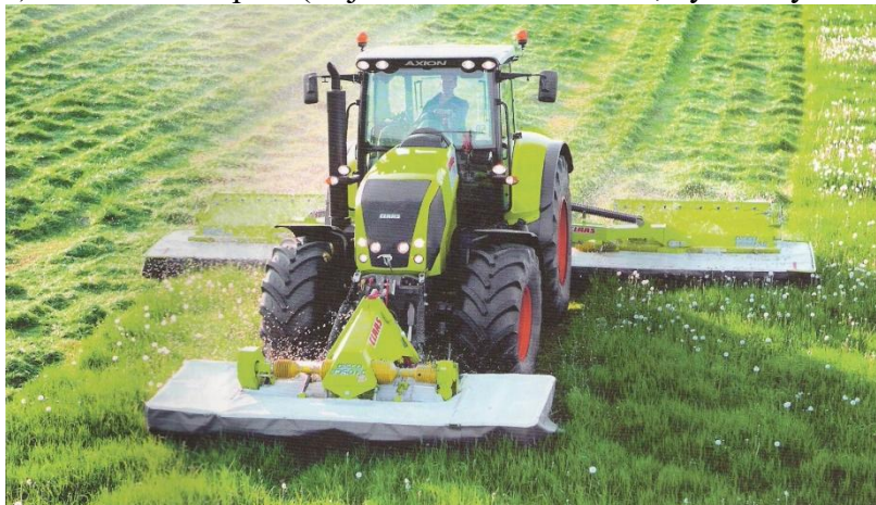
Trojkombová žací lišta nabízí velký pracovní záběr
