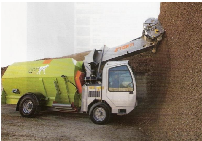
Obr. Samochodný krmný vůz s vybíračem senáže (siláže)
