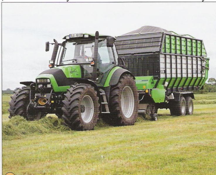
Senážní vozy Deutz-Fahr - K 7.44 mají ložný objem 44 m 3
