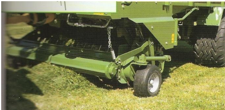
Obr. Bubnové s pružnými prsty a krycími plechy
