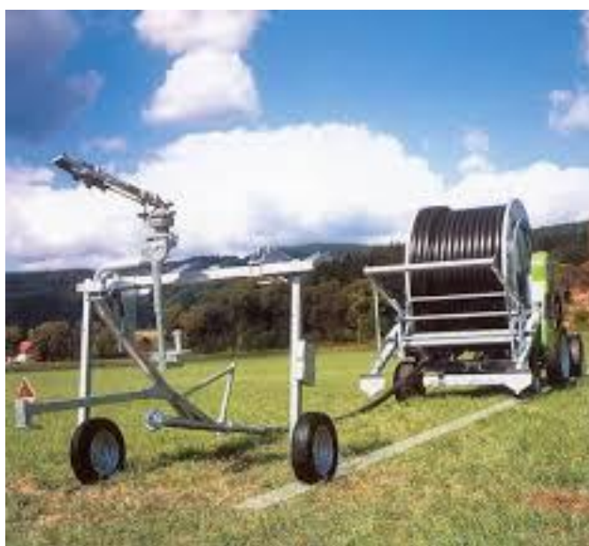
Obr. Částečně rozvinutá hadice pásového zavlažovače
