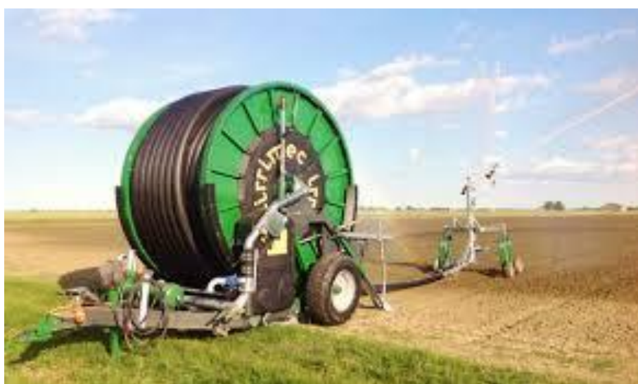
Obr. Zavlažování, hadice je navíjena k válci
