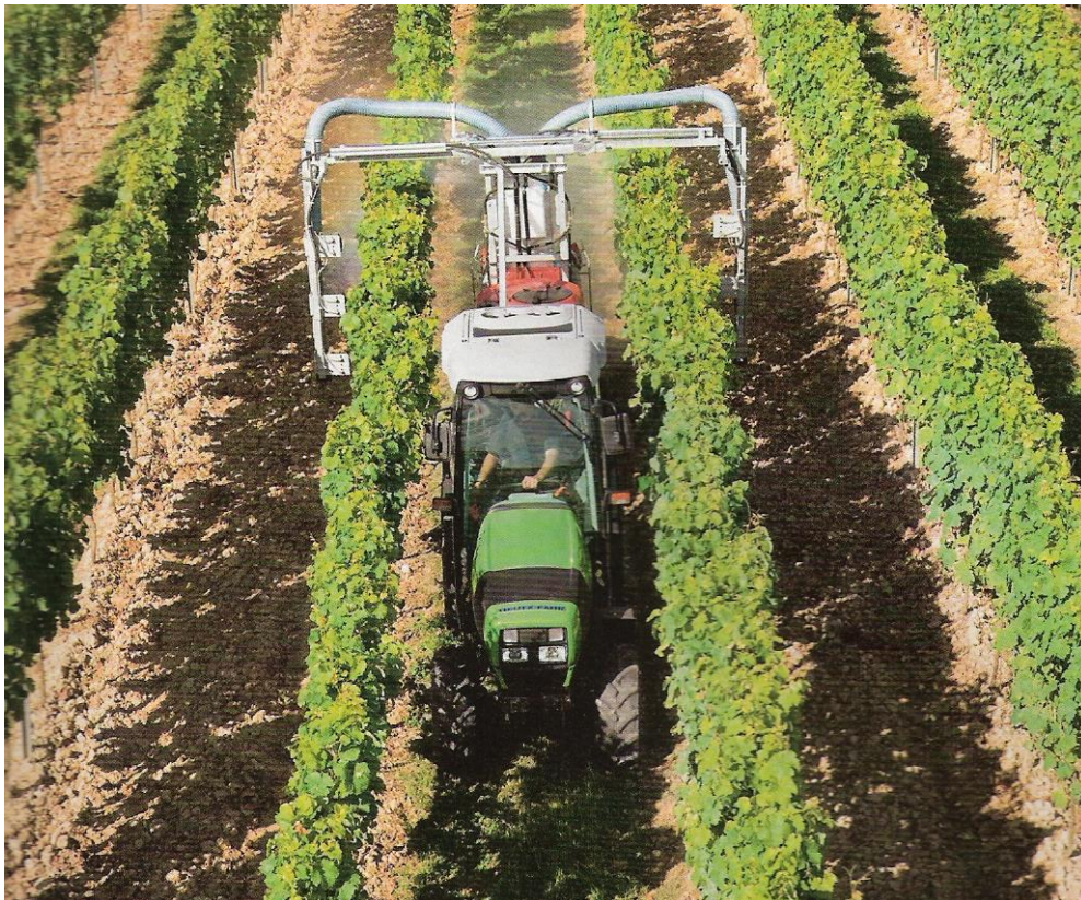
Obr. Rosič ve vinici. Dávka kapaliny je menší, objem nádrže proto může být malý
