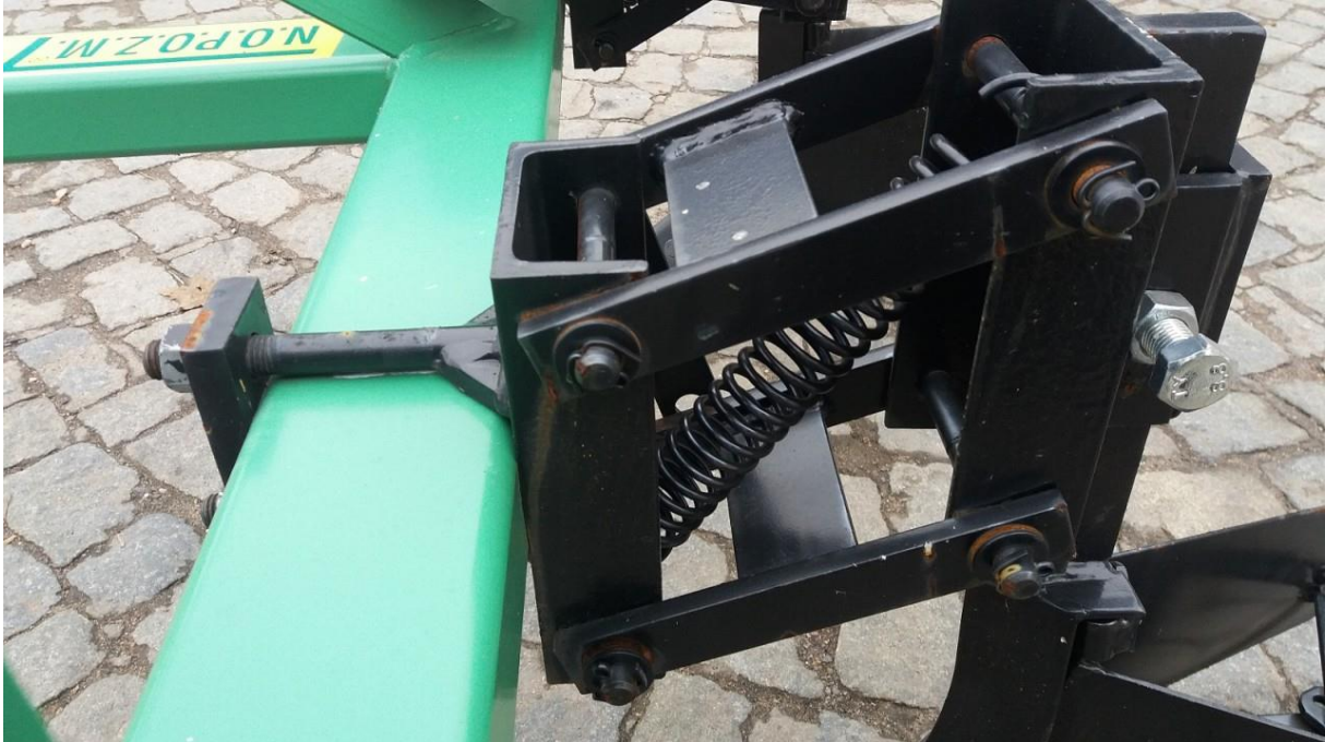
Obr. Čtyři klouby (čepy) závěsu jsou zřetelně vidět
