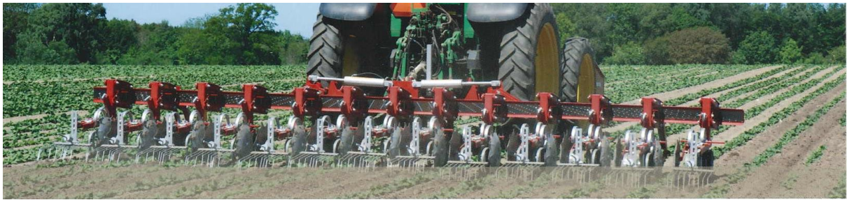
Obr. Všimněte si šíře pneumatik traktoru, které se musejí vejít do šíře meziřádku
