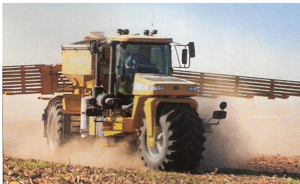
Unikátní nástavba AirMax s šířkou ramen až 21,3 m
