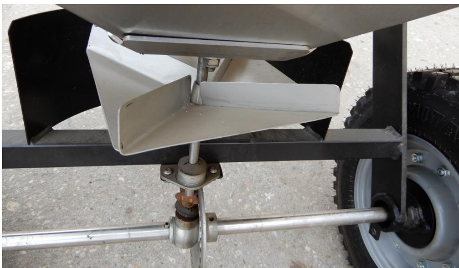
Rozmetací kotouč poháněný ozubeným kolem
