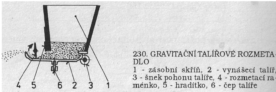
Obr. Gravitační rozmetací ústrojí
