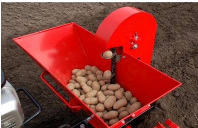
Obr. Dvojí provedení automatických elevátorových jednořádkových sazečů brambor
