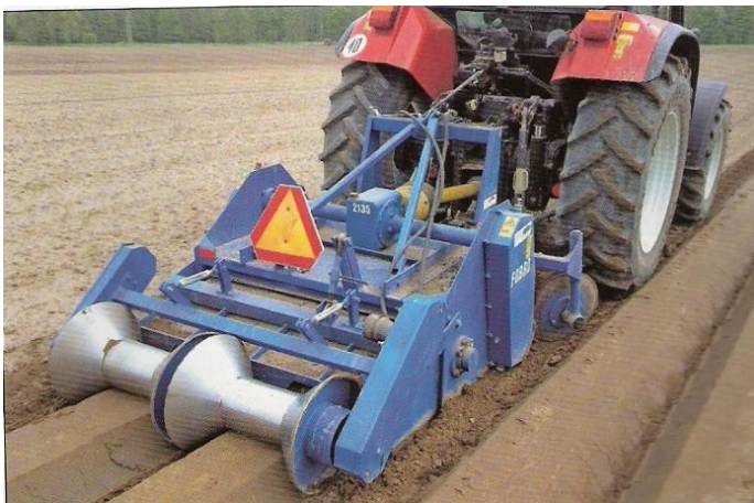
Obr. Tvorba hrůbků bez odkameňování. Používá se pro následnou výsadbu nebo setí do hrůbku.
