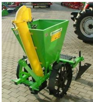
Obr. Dvojí provedení automatických elevátorových jednořádkových sazečů brambor
