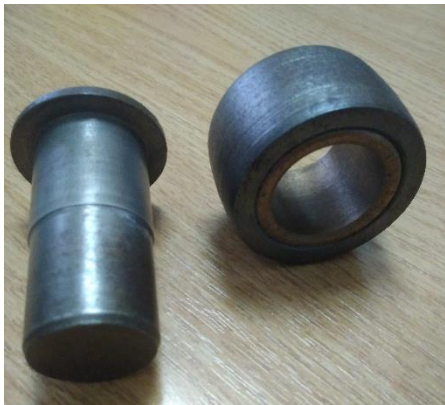
čep ložisko – těleso (ocel) a pouzdro (bronz)
