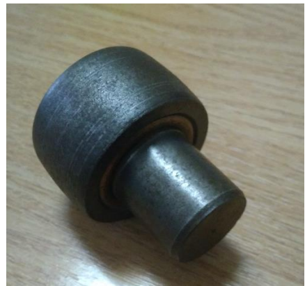
čep s ložiskem = funkční dvojice
