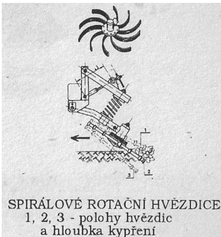
Obr. Rotační spirálové hvězdice – otočně uložené hvězdice jsou v rámu postavené šikmo na směr pohybu. Jednotlivé sekce se také používají jako plečkovací orgány.
