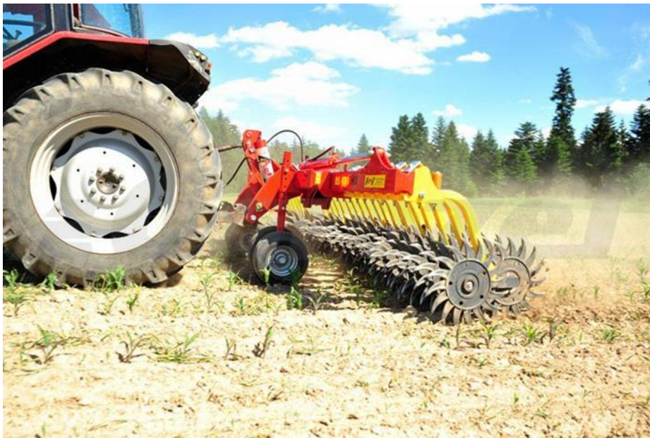
Obr. Rotační hvězdicové brány. Kotouče jsou šikmo na směr jízdy
