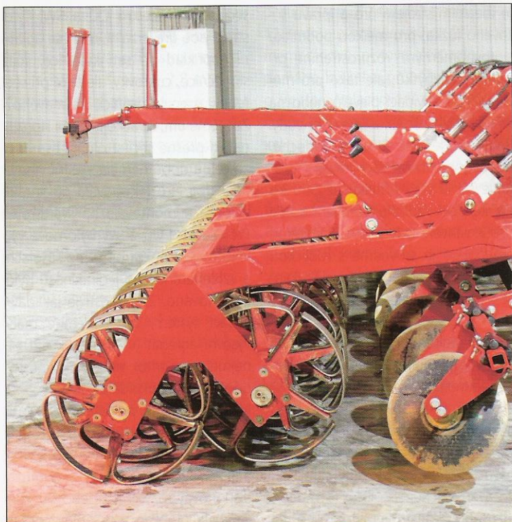
Nový dvouřadý pěch Doppel RollFlex. Výhodou tohoto nového pěchu je rozložení hmotnosti na větší plochu, a tím lepší drobní efekt
