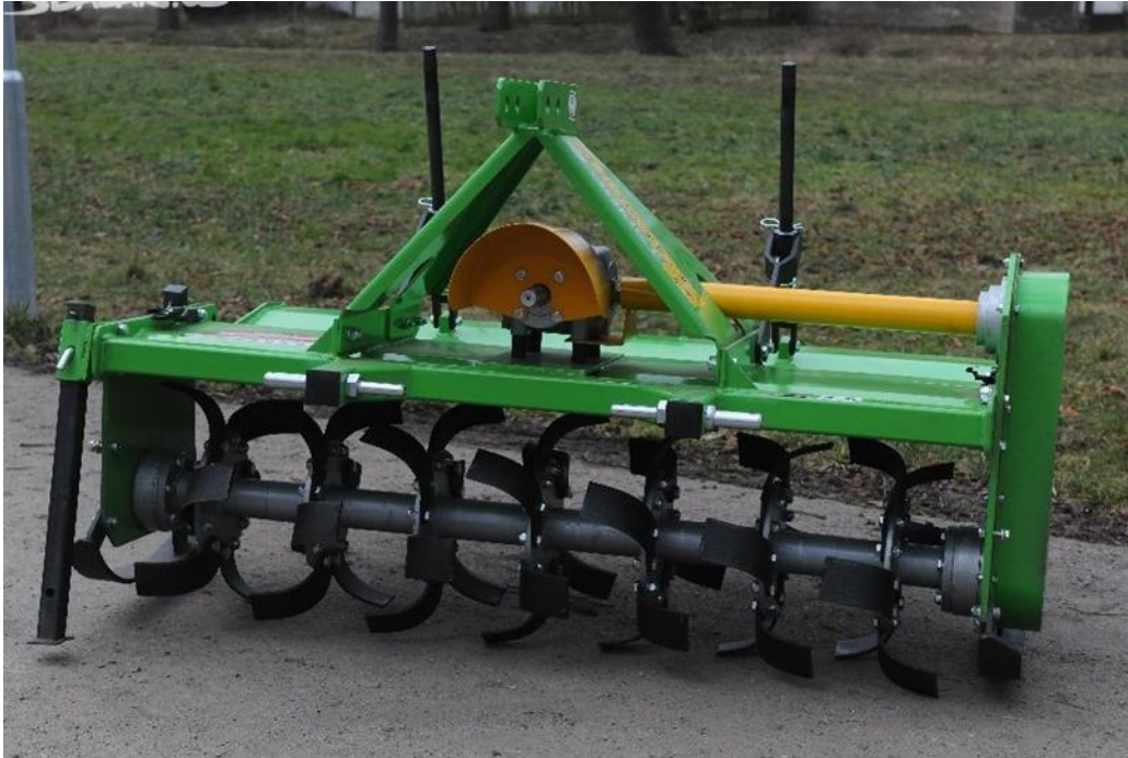
Obr. Kypřič s vodorovnou osou rotace, tzv. „rotavátor“
