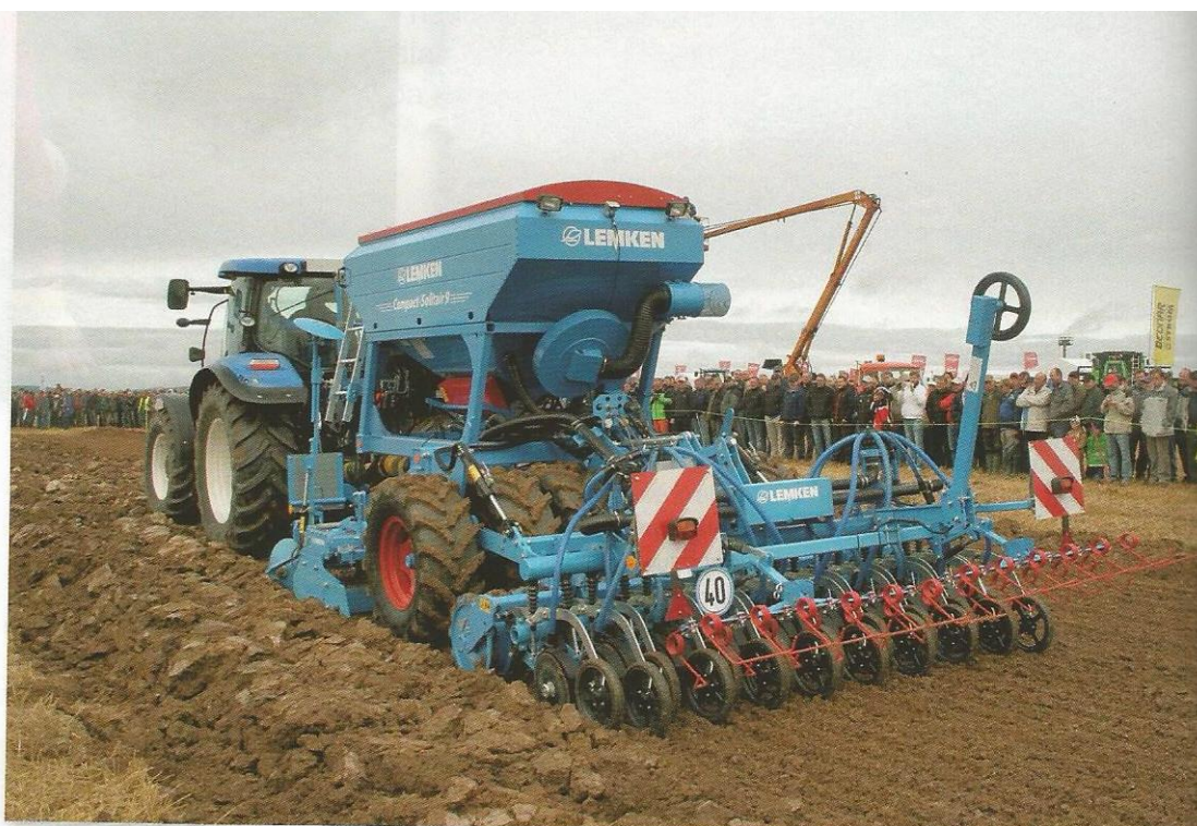
► Společnost Lemken Czech vybrala pro předvádění secí stroj Compact Solitair 9 s pracovním záběrem tři metry. Zpracovat půdu a připravit setové lože v této secí kombinaci je úkolem pro rotační brány Zirkon 10 společně s pneumatikovým pčhem, který může být ještě doplněn trapézovým válcem, připravujícím setové lůžko individuálně pro každou secí botku. Osivo je ze zásobníku o objemu 3500 l distribuováno přes dvě rozdělovací hlavy pneumaticky ke kotoučovým secím botkám (s hydraulicky nastavitelným přitlakem) vzdáleným od sebe 167 mm, doplněným zamačkávacím kolečkem a v případě potřeby i zavlačovačem. Pro ovládání stroje má obsluha k dispozici CCI terminál
