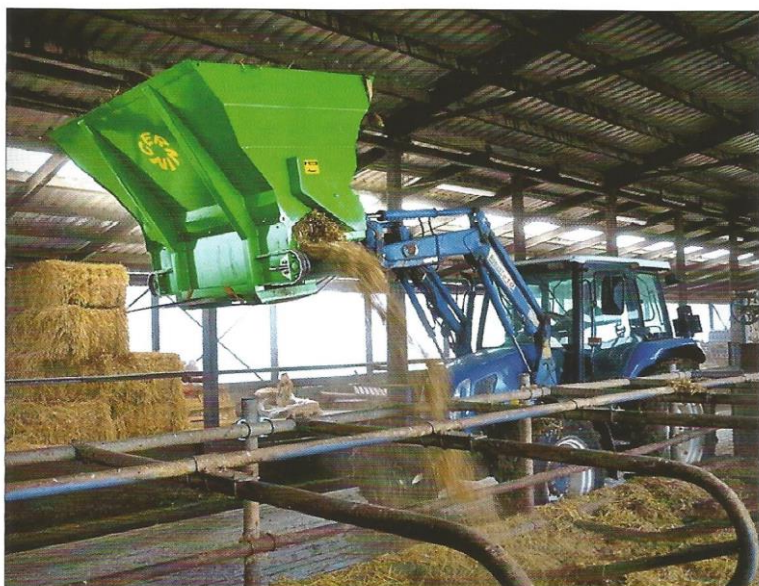
Obr. 2 - Nastýlání separátu pomocí rychloupínacího míchacího a nastýlacího zařízení L190
