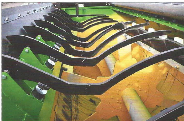
Vozy Keenan používají pádlový míchací systém, přesto umožňují zamíchání sena či slámy lisované v balících
