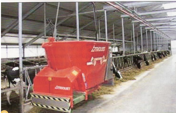
Obr. 3 – Nově se objevuje snaha o oživení stacionárních krmných systémů zajištěných novými stroji a zařízeními. Jedná se např. o využití vybavené korby míchacího krmného vozu zavěšené na drážce
