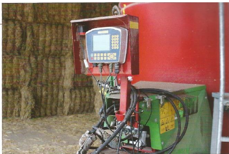
Na velké obrazovce ovládacího terminálu PTM Advance Super USB se zobrazují všechna potřebná data včetně hmotnosti nákladu. V ZEMOS Velké Němčice využívají možnosti přenosu dat z ovládacího terminálu do kanceláře pomocí USB flash disku
