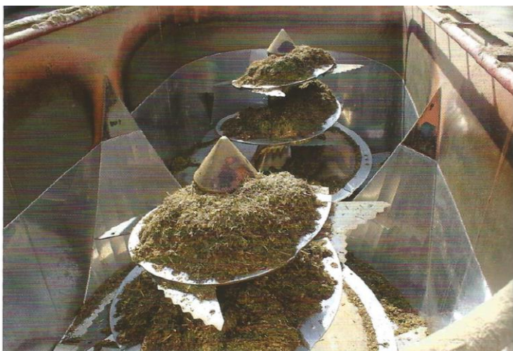
V konické vaně krmného vozu Strautmann Verti-Mix 2401 Double se otáčejí dva míchací šneky o rozdílné velikosti. Při nízké energetické náročnosti zajišťují rovnoměrné promísení všech komponent krmné dávky
