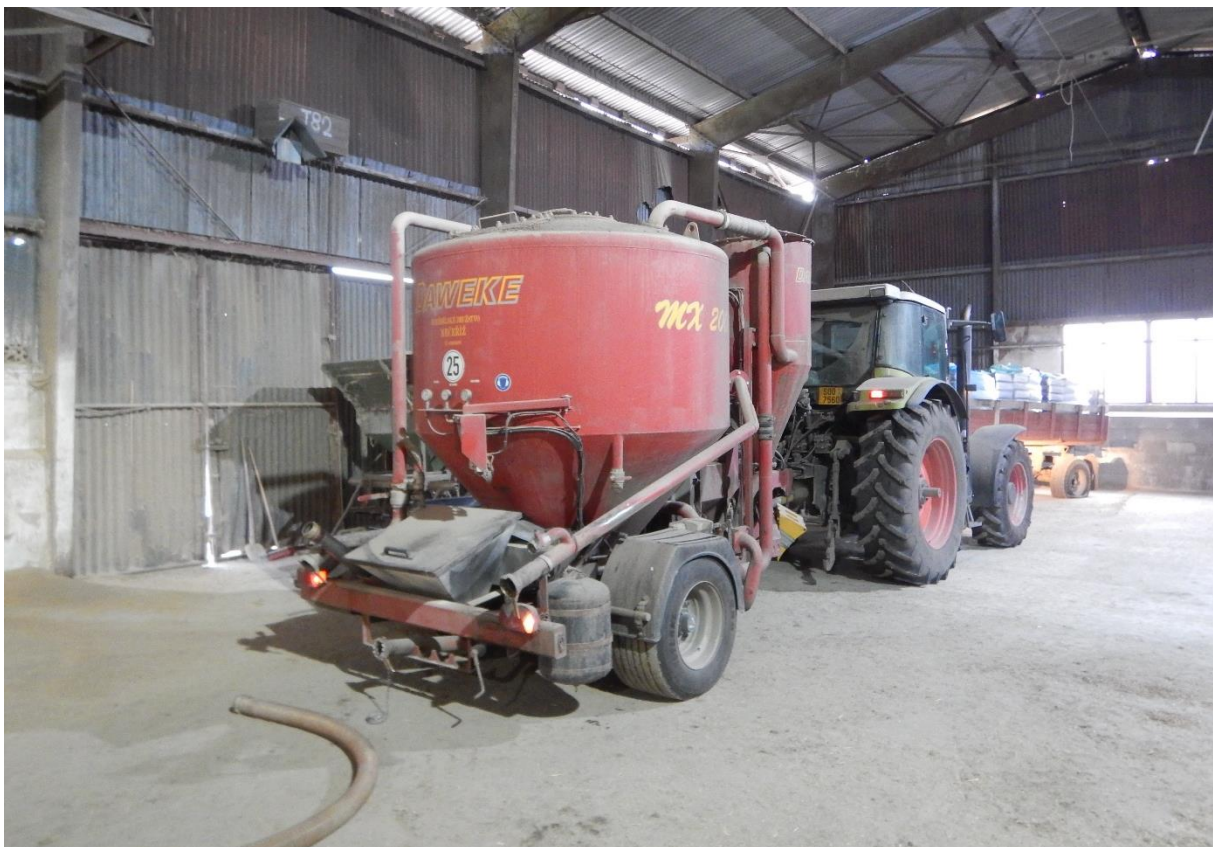
Obr. Moderní – mobilní šrotovník se zásobníkem. Pro dopravu zrna i šrotu využívá proudy vzduchu
