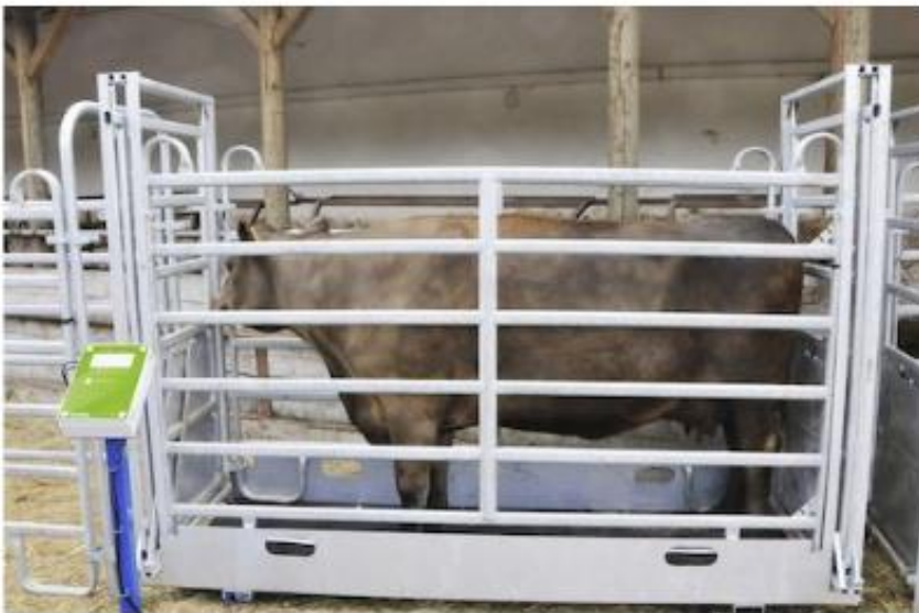
Obr. Průchozí váha pro dospělý skot
