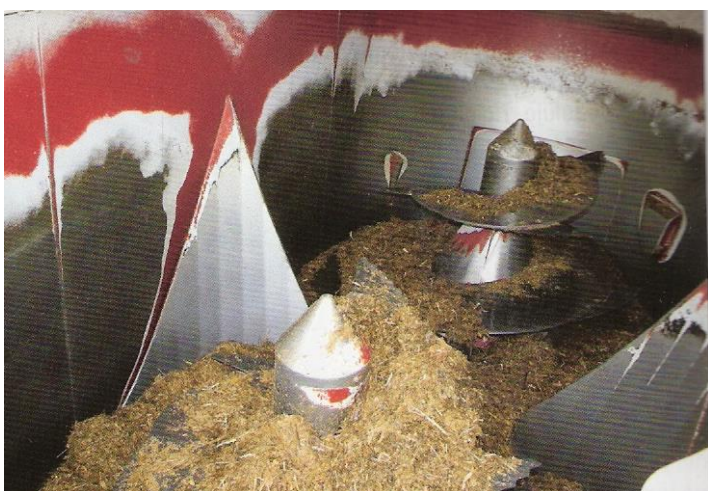
Obr. Jedno z možných provedení míchacích šneků v korbě krmného vozu
