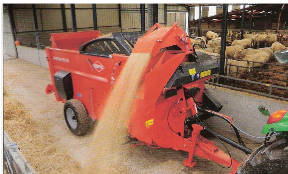
Obr. Rozdužovací krmný vůz pro zakládání sena. Použit ho lze i na nastýlání slámou
