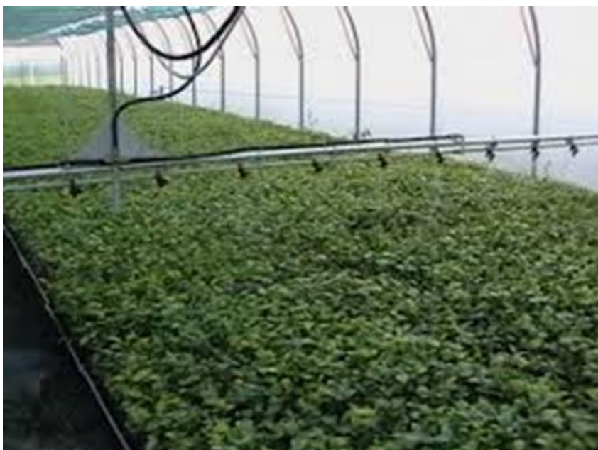
Obr. Mostová výložníková závlaha ve skleníku
