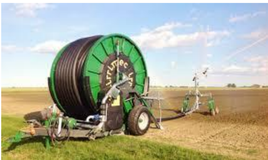
Obr. Zavlažování, hadice je navíjena k válci
