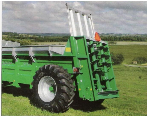
Rozhoz je jemný se souvislou vrstvou o šířce 12 m, což zajišťují svislá rozmetací ústrojí. Na obrázku je rozmetadlo SP15 s hydraulickou bránou a bočnicemi pro seno či siláž
