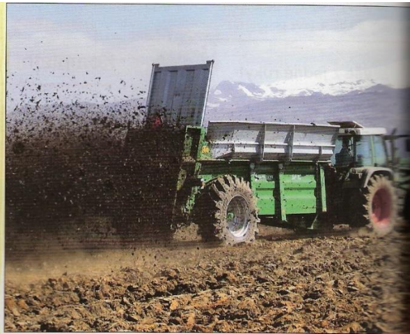
Rozhoz je jemný se souvislou vrstvou o šířce 12 m, což zajišťují svislá rozmetací ústrojí. Na obrázku je rozmetadlo SP15 s hydraulickou bránou a bočnicemi pro seno či siláž
