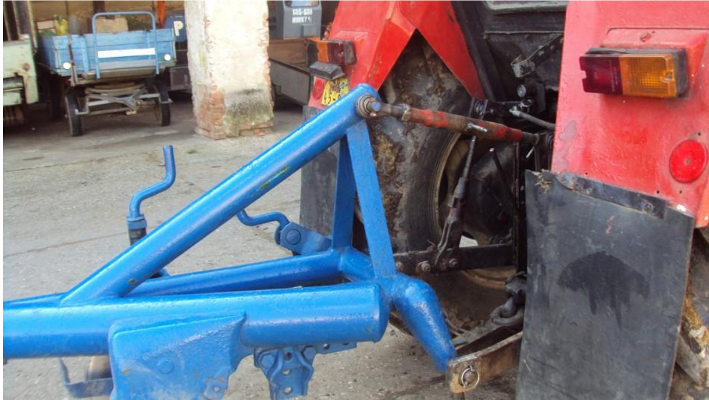
Připojení pluhu za traktor - Tříbodový závěs
