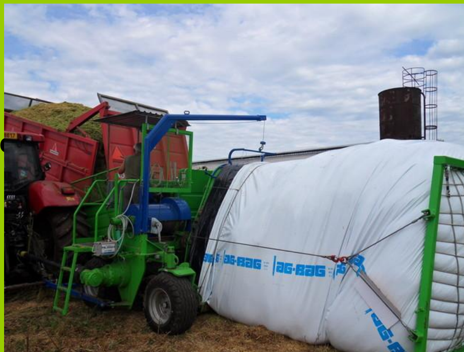
Lisování do vaků Vakovací lis AG – Bagger G – 7000 Europe
