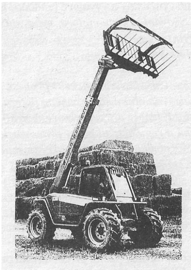
Obr. Samojízdný nakladač (manipulátor) s teleskopickým ramenem
